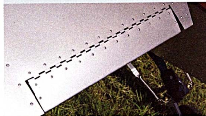
DIE TRIMMUNG wird elektrisch betätigt.
