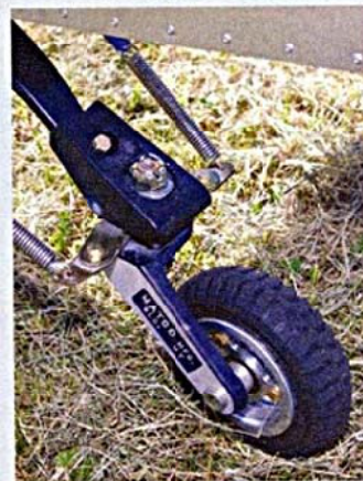
DAS SPORNRAD lässt sich für enge Kurven aushängen.
