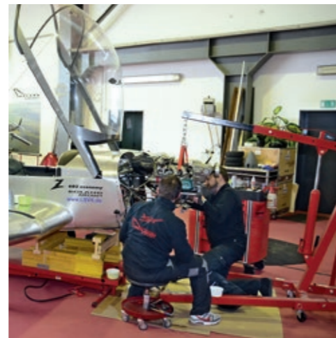
Service Zwei Mitarbeiter tauschen die Gummilager zwischen Rotax 912 ULS und Motorträger aus
