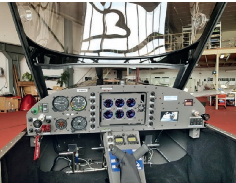
Typisch Roland Aircraft Gesteuert wird per Zentralknüppel mit Y-Handgriffen. Diese Z-602 hat eine ICFly-Motorbox mit Rundinstrumenten
