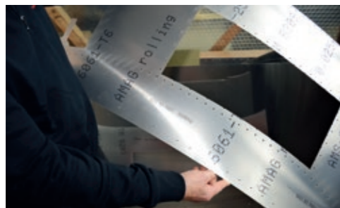
Präzisionsarbeit Auch gebohrt wird maschinell. Jedes Blechteil erhält die Seriennummer des Fliegers, für den es bestimmt ist
