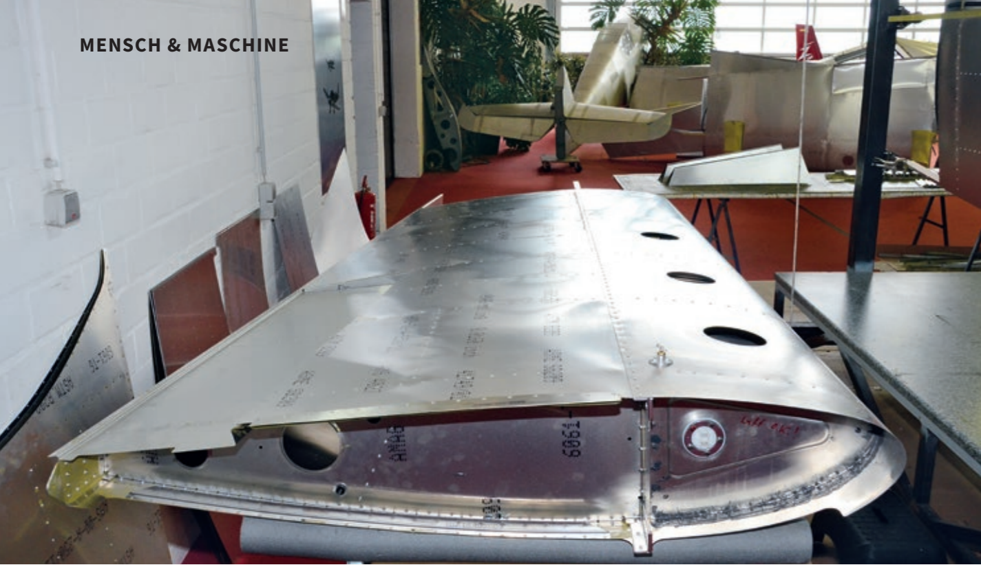
Wetwing Jede Flügelhälfte (hier über Kopf) nimmt vor dem Hauptholm einen Tank auf. Die Struktur ist so abgedichtet, dass sich ein extra Behälter erübrigt
