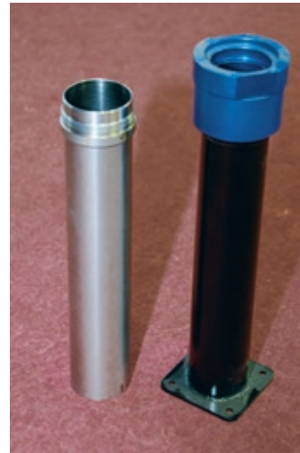
Wahlweise Das Hauptfahrwerk gibt's mit Tauchrohren für Gummizug- und für Luftfederung (rechts). Im Einziehfahrwerk wird ausschließlich Luftfederung verbaut
