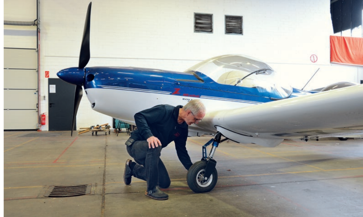
Alleinstellungsmerkmal Die Z-602 ist nicht nur mit Bug-, sondern auch mit Spornradfahrwerk erhältlich und als Taildragger sogar mit Einziehfahrwerk (im Bild)
