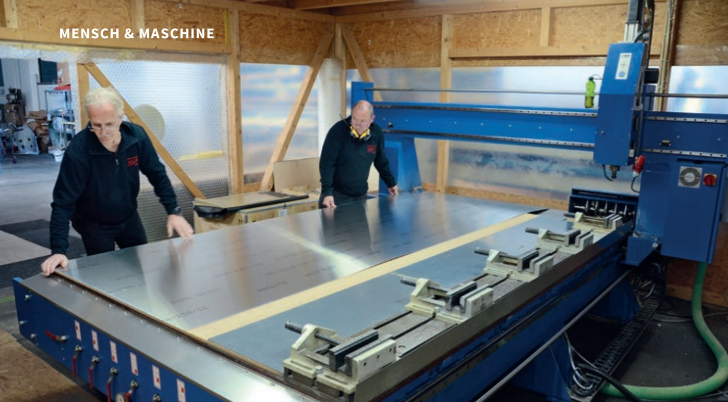
»Das wichtigste Werkzeug« Eine CNC-Fräse schneidet sämtliche Bleche zu. Das Aluminium kommt vor allem aus Österreich
